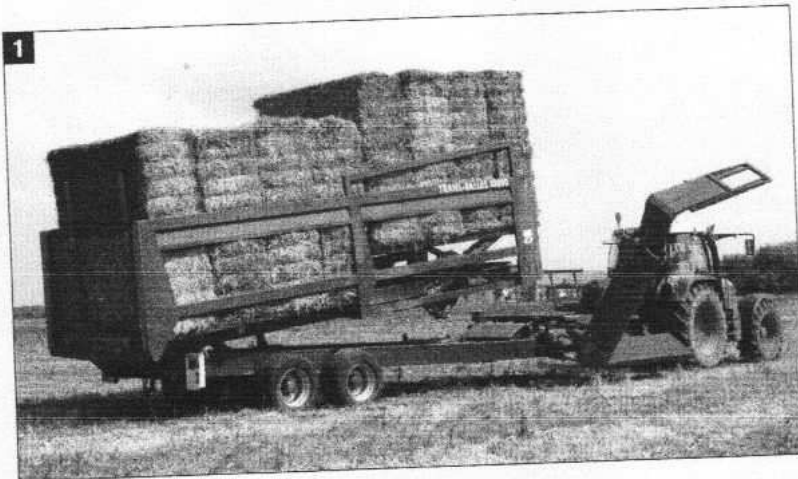
1. DÉCALAGE Certains modèles reçoivent un dispositif de décalage qui augmente la stabilité de la meule.
